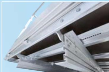
Der von 180 mm bis 245 mm höhenverstellbare Aluminium HilfsLängsträger wird vorne und hinten mit Befestigungswinkeln am Kopfraum verschraubt. Verschiedene Spurbreiten sind möglich durch die gelochten Querträger.
