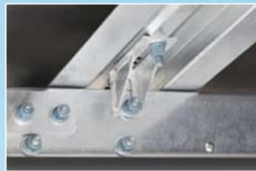
Zusätzliche Haltewinkel am HilfsLängsträger erhöhen die Stabilität der Pritsche. Verbindung Außenrahmen - Hutprofile - mit unseren speziellen Rändelbolzen.
