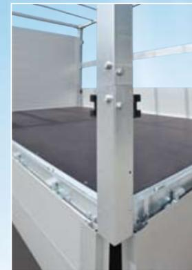
Eckungen aus feuerverzinktem Stahl zur Aufnahme des Geräteträgers oder Dachgestells.
