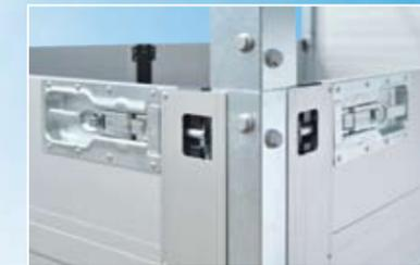
T-Riegelverschlüsse erleichtern das Schließen der Bordwände auch bei extremer Belastung - die Übereckvariante ist ebenfalls möglich.
